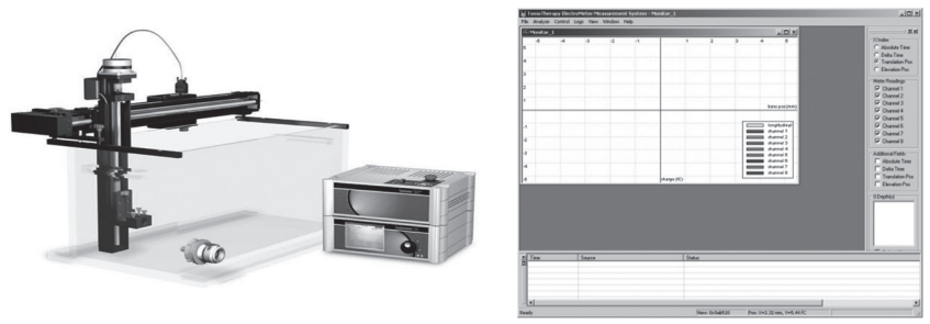
Рис. 12. Водный фантом с контроллером, электрометром и программным обеспечением
